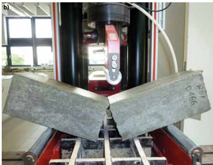
Rys. 4. Badanie wytrzymałości na zginanie a) obciążenie dwupunktowe, b) obciążenie jednopunktowe [fot. własna]
