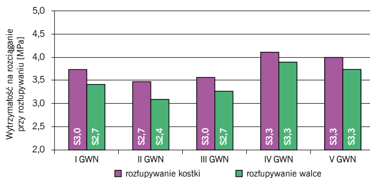
Rys. 3. Zestawienie średnich wytrzymałości na rozciąganie przy rozłupywaniu betonu stosowanego do górnej warstwy nawierzchni w zależności od rodzaju próbek do badań
