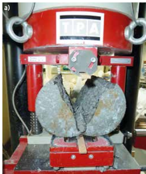
Rys. 2. Badanie wytrzymałości na rozciąganie przy rozłupywaniu a) na próbkach cylindrycznych, b) na próbkach sześciennych [fot. własna]
