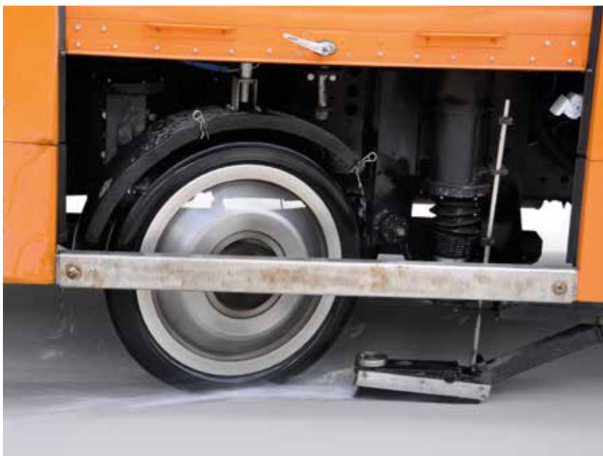
Rys. 3. Pomiar współczynnika tarcia metodą SKM [źródło: archiwum TPA]
