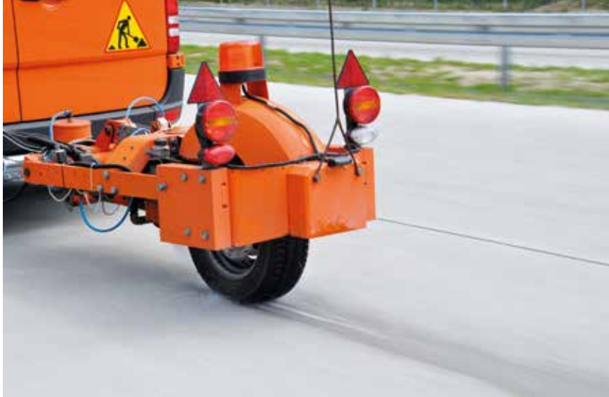
Rys. 2. Pomiar współczynnika tarcia metodą SRT-3 [źródło: archiwum TPA]
